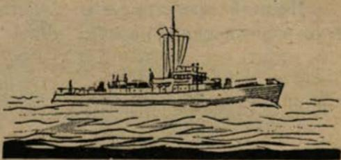
**Бързитѣ лодки** сж „хрѣткитѣ на моретата“. Това сж малки моторни лодки съ здраво вградени торпедни трѣби. Бързитѣ лодки се плѣзгатъ съ голѣма скоростъ надъ водата и представятъ едно опасно оржие, за-
