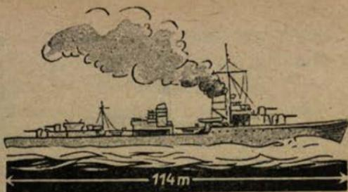
**Минотърсачнитѣ лодки** иматъ за задача да откриватъ и очистватъ миннитѣ заграждения, които неприятелтъ е поставилъ тайно. За тая цель между минотърсачнитѣ лодки се опѣва вжже и чрезъ особени приспособления се поддържа на опредѣлена морска дълбочина. Когато лодкитѣ се движатъ презъ едно минно поле, тогава вжжето прерѣзва котвеното вжже на мината. Минотърсачнитѣ лодки сж отъ 500 до 600 тона.
