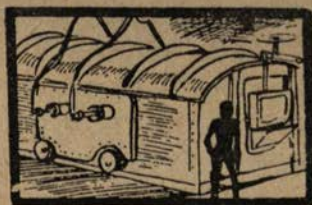
Водата се изпарява. Въ пещта остава чистъ алуминиевъ окисъ. За да се получи чистъ алуминий, трѣбва да се отстрани кислородътъ. Това става чрезъ електрически токъ.
