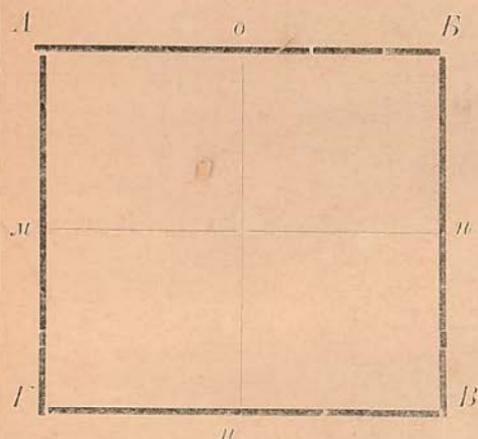
*2 Ость.* За да направимъ една или двѣ оси върху книгата, пола име странитѣ  $A C$  върху  $C B$  и  $B D$  върху  $A D$  и ще получимъ линията  $o n$  (обр. 2), която се нарича ость, също и линията  $m n$ .
